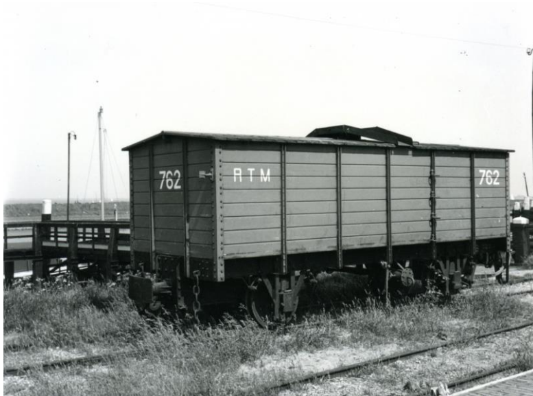
Op de eilanden was zoetwater voor de stoomlocomotieven soms schaars. De RTM bracht dan water met een waterwagen naar zo'n punt, zodat de dienstuitvoering verzekerd bleef. Middelharnis-Haven, 1 juni 1958.
