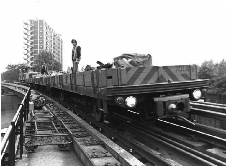
Spoorijzer maakte acht 2-assige werkwagens voor het RET-metrobedrijf. Railtransportwagen 7014 op het metroviaduct in de Mijnsherenlaan.
