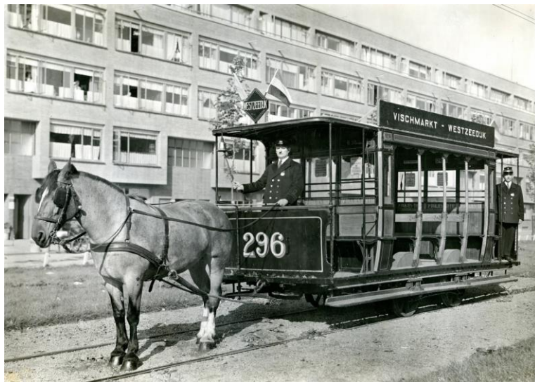
Rijtuig 188 werd in 1934 terugverbouwd tot paardentramrijtuig, maar behield het laatste nummer uit z'n tijd als aanhangrijtuig. RET-statiefoto t.g.v. VVV-week, Schieweg, 1934 .
